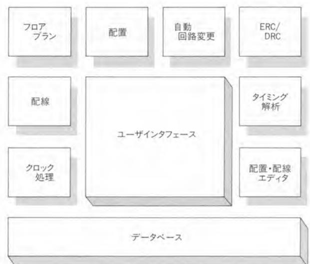
図 1. システムの構成 システムは配置・配線、タイミング解析、自動回路変更、クロック処理、フロアプランなどで構成される。
