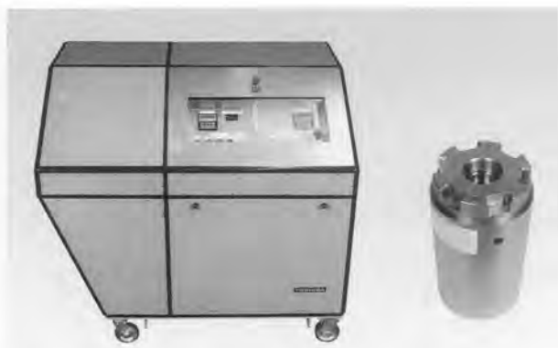
図6. 油圧発生装置と油圧シリンダ 左側の油圧発生装置と右側の油圧シリンダが高圧ホースで接続される。
