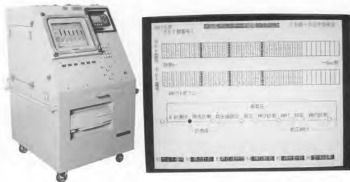
図4. データ処理装置と画面例 筐体内にFAパソコン、超音波ボルト伸び計測器、レーザプリンタが組込まれている。
