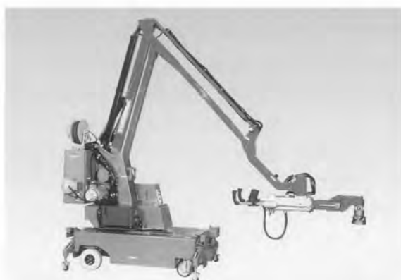
図5. ナット自動締付装置 自走台車にバランスアームとナットランナが設置されている。
