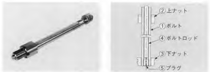
図2. 油圧ボルト ボルト中央穴に、油圧力をボルトに伝達するボルトロッドが挿入されている。
