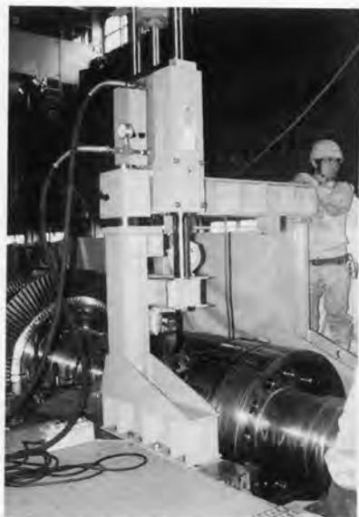
図7. ポータブル型油圧式タービンロータ回転装置の適用 実機に適用しロータを回転させている。従来の作業に比べ回転時間が1/4に、作業員が7人から2人に省力化できる。
