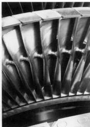
図4. スナバ翼構造 50Hz, 33.5インチ L-1 スナバ翼の組立状態を示す。
