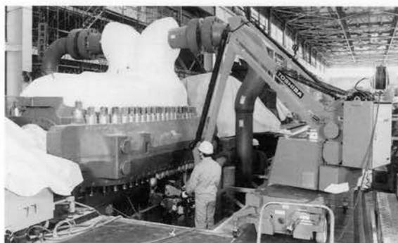
図1. ケーシングボルト自動締付け作業 自動締付け装置のグリップ操作でフランジ下部に下ナットを取り付けている。
