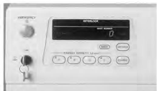
図5. 操作パネル “ENERGY DENSITY”スイッチでエネルギー密度を選択し、治療する。
