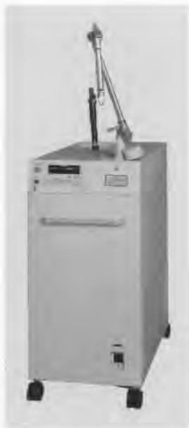
図1. Qスイッチ型治療用ルビーレーザー装置 LRT-301A/QS ピークパワー密度  $200\text{MW}/\text{cm}^2$ 以上, 照射時間約  $30\text{ns}$  でエネルギー密度は  $4\sim 7\text{J}/\text{cm}^2$ と少ない。
