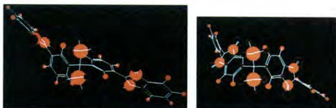
図3. ヘキサフロロイソプロピリデン基をもつビスイミドモデル化合物の電子分布 (a), (b)とも電子吸引性のトリフロロメチル基上の負電荷が非常に大きくなる。
