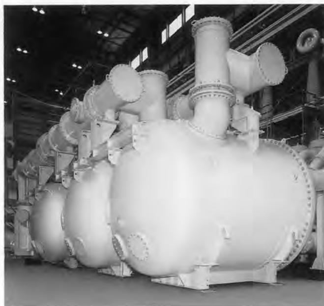
図 9. 275kV-300MVA ガス絶縁変圧器 世界初のガス冷却式大容量器で、丸形の压力容器タンクを 3 個ならべた特別三相構成になっている。
