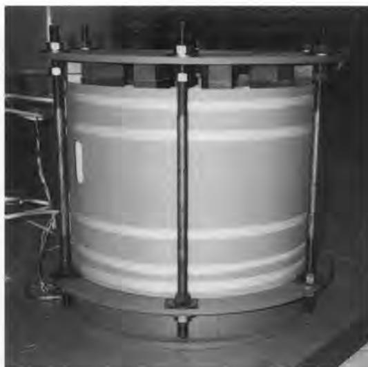
図7. 流動帯電検証試験供試巻線 実器と同じ断面形状をもつ巻線を用いて試験した。
