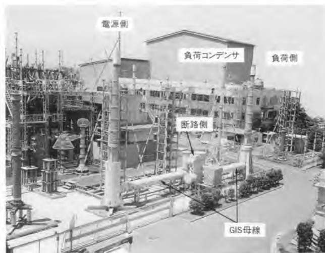
図 21. 1,000kV 断路器の進み小電流遮断試験 高周波サージ電圧を精密に模擬して 400 回の遮断試験を実施した。
