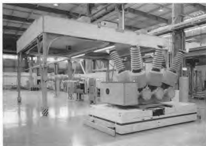
図 18. 電動台車による製品の搬送 製品は組立ステーションおよび試験工程へ電動台車で無人搬送される。
