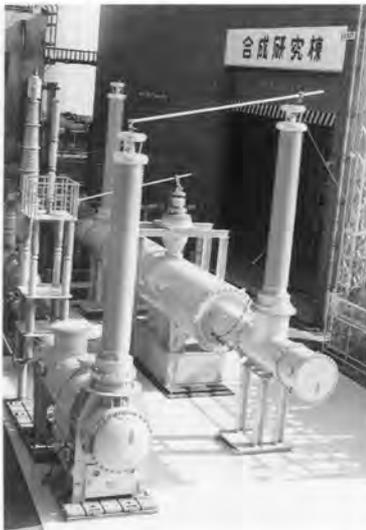
図5. コンポジット型ガスブッシングを使用したガス遮断器の遮断試験実施例 コンポジット型ガスブッシングは軽量で取扱いが容易なため、開発試験の効率がアップしている。
