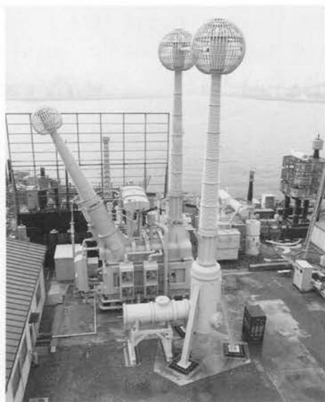
図7. 長期課電試験中のUHVプロトタイプ変圧器 長期運転信頼性検証のため1.2Eの過電圧で3年以上の課電を実施した。
