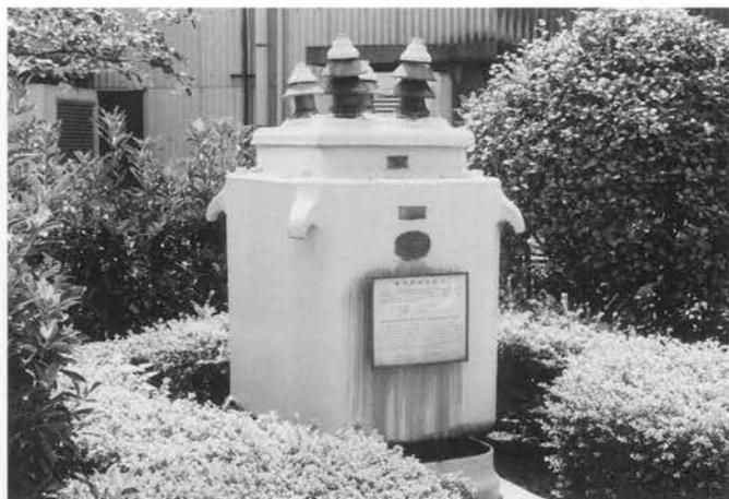
図1. 現存する最古と考えられる13.2kV-100kVA特別高圧変圧器 この変圧器が作られた1910年当時は、まだ10kVA以下の配電用変圧器がほとんどであった。
