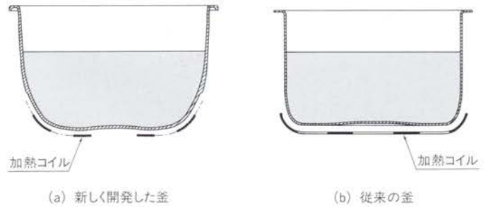
図2. 釜の形状比較 新しい釜は従来に比べ、底部が大きな曲面となっている。
