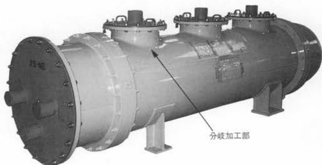
図7. GIS用タンク 回転分岐加工を適用したGIS用タンクは、素材はアルミニウム合金で、最大肉厚15mm、最大素管直径1,500mmである。 Gas-insulated switchgear tank
