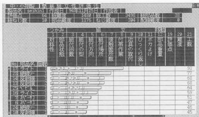
図3. 評価結果例 グラフ化し昇順した。ワースト部品がわかり、改善の効率化ができる。
