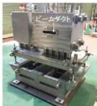
図1 高温超伝導電磁石の外観
