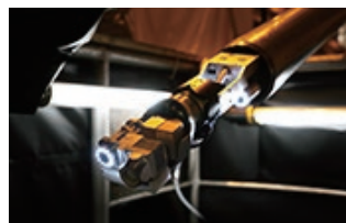
2号機原子炉格納容器内調査装置
