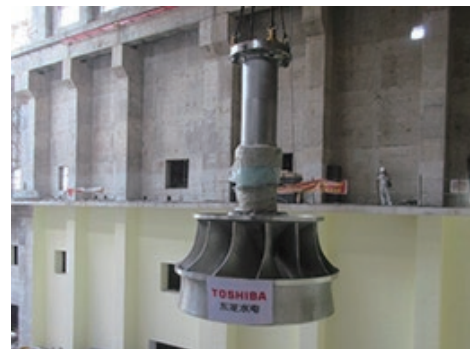
チュンソン水力発電所に納入した水車
