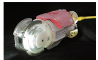
3号機原子炉格納容器内調査用 水中ROV
