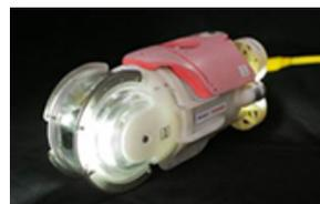
原子炉格納容器内調査用水中ROV
