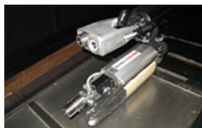
原子炉格納容器内調査ロボット
