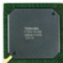
REGZA用システムLSI 高画質処理に加え、外付けハードディスクへの録画機能やネットワーク機能も制御
