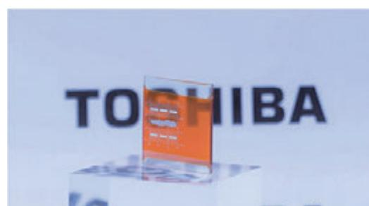
図2:透過型Cu<sub>2</sub>O太陽電池
