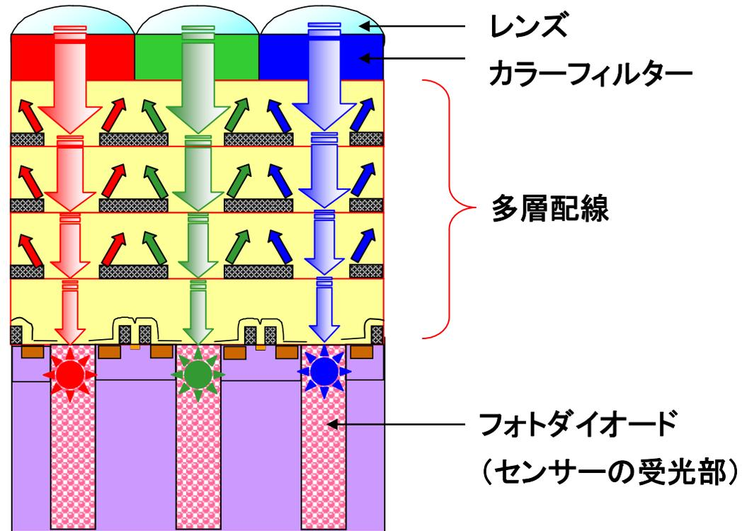
受光部の上に配線層を形成し、レンズを取り付ける。光は配線の合間を通過して届くので、斜めの光は遮られ、配線による反射もあるため、感度が低下してしまう。
