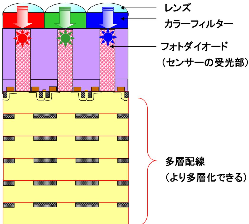
受光部と配線層ができた後、基板の裏面を削って受光部に近接してレンズを取り付ける。このため、配線の影響を受けず感度が向上する。
