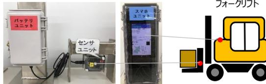
②スマートフォンのアプリを起動し、スタートボタンを押したら、データ収集を開始される。必要に応じてバッテリー交換する。
