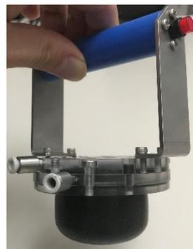
柔軟膜内部を減圧することで、内部の粉粒体が固化するジャミング転移現象と、吸着機能を組み合わせたユニットで、様々な対象物を把持可能です。
