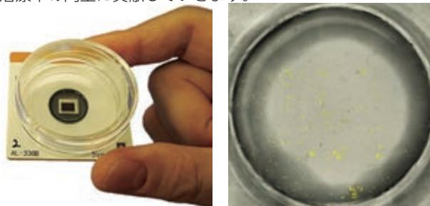
細胞培養用に独自開発したCMOSイメージセンサー(左)と撮像した乳がん細胞(右)
