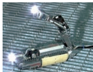
原子炉格納容器の内部調査用小型ロボット 国の「廃炉・汚染水対策事業費補助金」活用 (開発: IRID/東芝)
