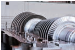
コンバインドサイクル発電用蒸気タービン
