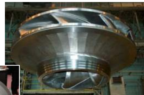
揚水発電用ポンプ水車
