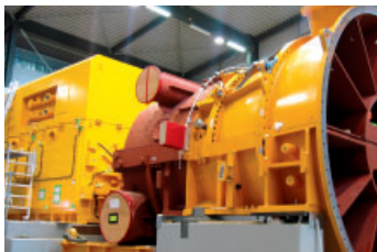
アイスランド・ヘリシェイディ地熱発電所向け地熱タービン
