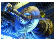
蒸気タービン
