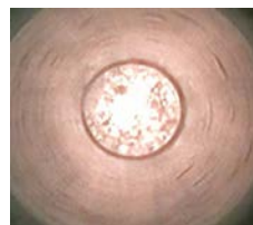
写真中央が燃焼器 内部の火炎の状況
