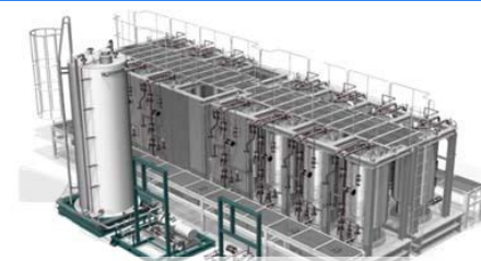
多核種除去設備
