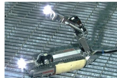
原子炉格納容器内部調査ロボット
