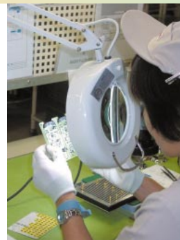
基板の目視検査
