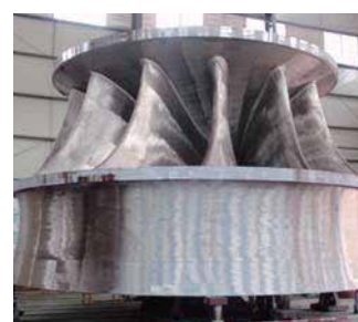
水の力により回転する 水車ランナ
