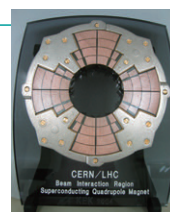
超伝導4極電磁石(MQX-A)
