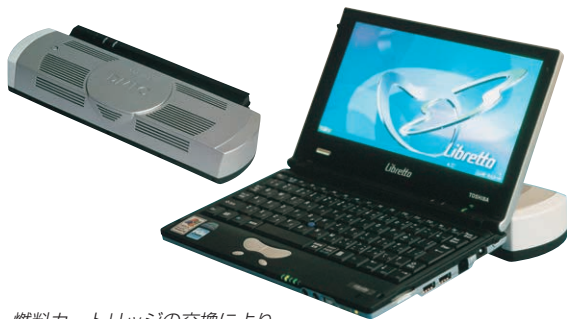
燃料カートリッジの交換により 充電せずにPCを長時間楽しめる燃料電池
