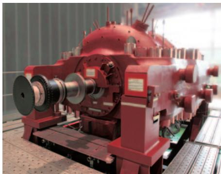
米国において、燃料、酸素と二酸化炭素を一緒に燃焼させ生じた高温、高圧の超臨界二酸化炭素でタービンを駆動させる直接燃焼方式の火力発電システムの実証試験が世界で初めて行われます。高効率で、環境調和型のコンパクトなシステムです。このプラント向けに当社が納入したタービン(出力2.5万千瓦ワット)は、既存のタービンの10倍以上の圧力を受け、1,000℃を超える高温にさらされ続けるため、これまで培ってきた蒸気タービンとタービンの技術の粋を結集して開発しました。
