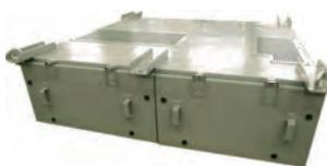
自社製造の1.7kV-All-SiCパッケージを用いた鉄道車両用150kW電力変換器を開発しました。スイッチング周波数を従来の4.5kHzから16kHzに高周波化、定格負荷での効率96%を達成したほか、体積で40%、重量で60%の削減を実証しました。(この開発はNEDOの「戦略的省エネルギー技術革新プログラム」の助成を受けて実施しました。)
