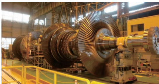
インド サラヤ超臨界石炭火力発電所向けと同型の蒸気タービン発電設備
