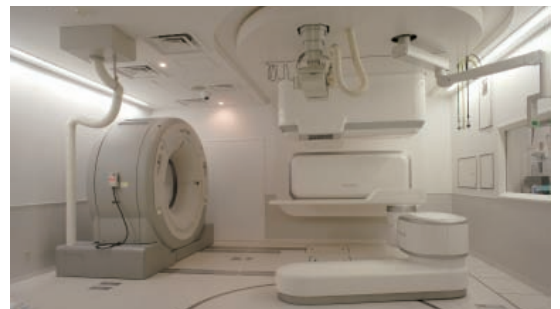
(独)放射線医学総合研究所の重粒子線治療室向けに納めた次世代重粒子線照射装置(室内右奥)と大口径CT(室内左奥)
