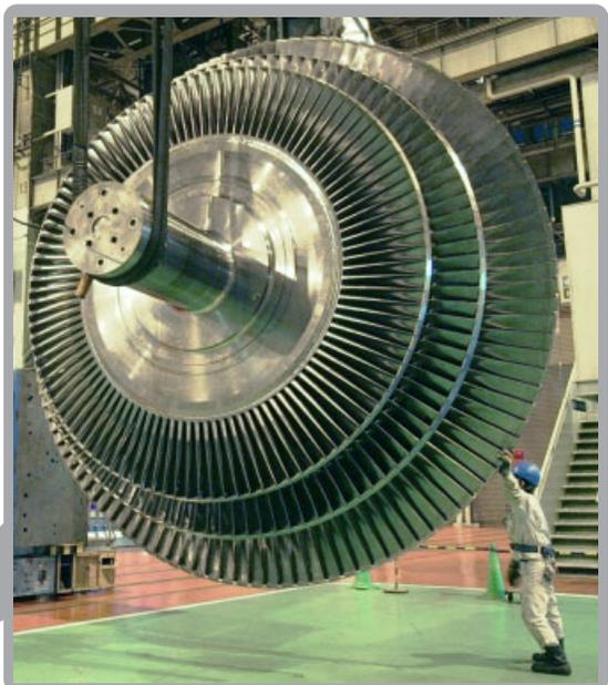
加圧水型軽水炉 AP1000™ 向け蒸気タービン
