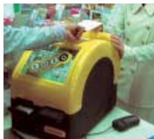
toto発券端末機はスポーツ振興くじ「toto」の販売、会員登録、デビット決済機能を備えたオンライン端末機で全国6,000台以上が稼働しています。2000年度グッドデザイン賞を受賞しました。
