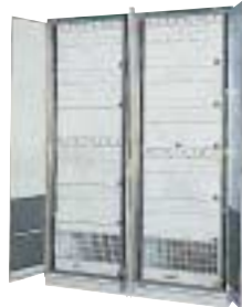
網切替装置は障害時の最短ルートを自動的に選択し復旧する大洋横断型プロテクション機能を世界で初めて実用化し、高速大容量光海底ケーブルシステムの中核をなします。
