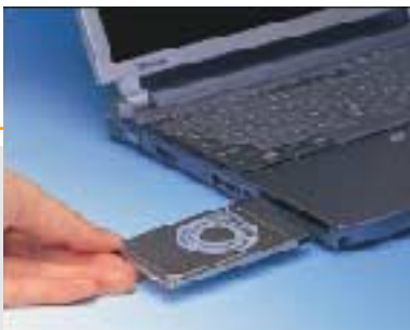
1.8型で5mm厚の小型超薄型ながら2ギガバイトの大容量を実現したHDDを開発しました。
