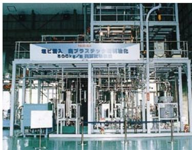
当社は塩化ビニールが最大50%まで混入した廃プラスチックを燃料油として生成する廃プラスチック油化処理装置を開発しました。
