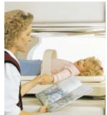
当社が開発したMRI「Opact」は、超伝導磁石冷却用のヘリウムの補充を無くすことで、維持費用を削減すると共に、患者に対する圧迫感を軽減しています。
