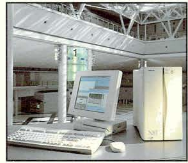
64ビット高速CPU Ultra SPARCを搭載し、従来 機種との2～3倍の高速演算処理を実現した “XECT AS8000”は複雑な解析やシミュレ ーション、インターネットサーバーに最適です。
