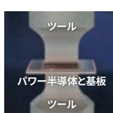
超音波接合 Ultrasonic Welding
