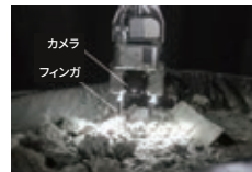
福島第一原子力発電所 堆積物調査装置 Investigation Device inside of the Primary Containment Vessel
