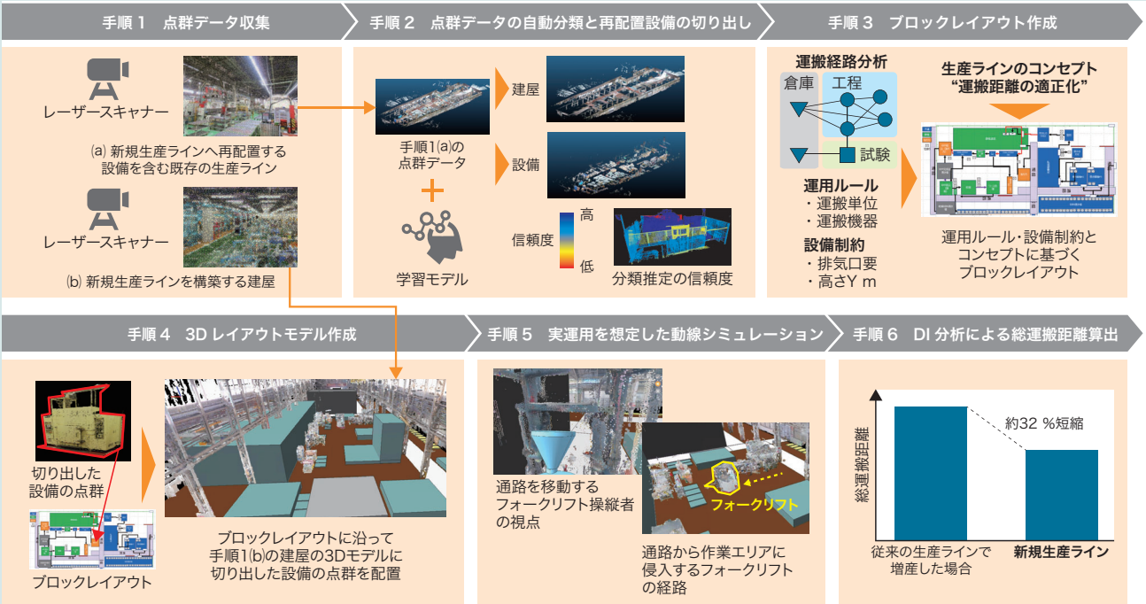
図1. 3Dモデルを活用したレイアウト設計の手順 点群データから設備を自動分類します。3Dモデルを活用して人やモノの移動を検証することで総運搬距離を短縮できました。
