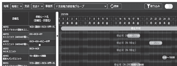
図2. 停止可能日への停電作業要求の割り付け結果の表示例
