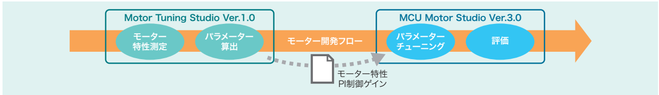
Motor Tuning Studio Ver.1.0 と MCU Motor Studio Ver.3.0 を使用した開発フロー Development process using Motor Tuning Studio Version 1.0 and MCU Motor Studio Version 3.0
