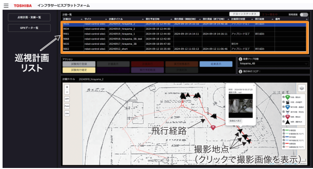
図5. ドローンによる巡視点検の実行計画及び結果の画面表示例 ドローンへの巡視計画の実行指示、及び建屋図面上での飛行経路と撮影画像の確認ができる。 Example of display showing drone patrol plan, flight route, and captured image
