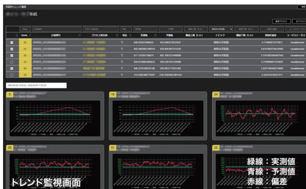
図1. TOSHIBA SPINEX for Energyの異常予兆検知システム
