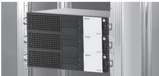
図2. FR2100TXの19インチラックへの実装例
